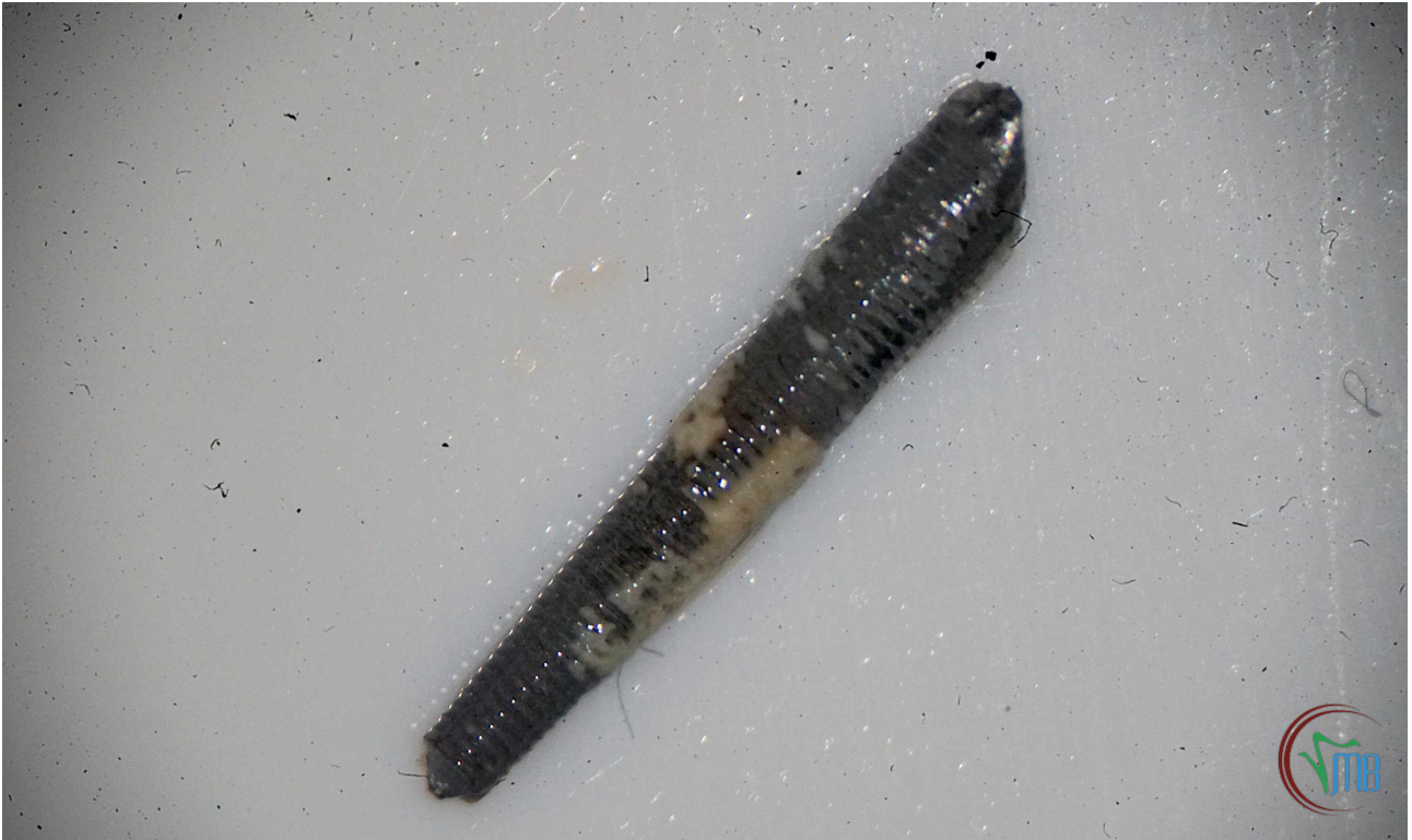
Der angegossene Stift ist ca. 10mm lang und mit einem Schraubengewinde versehen.
